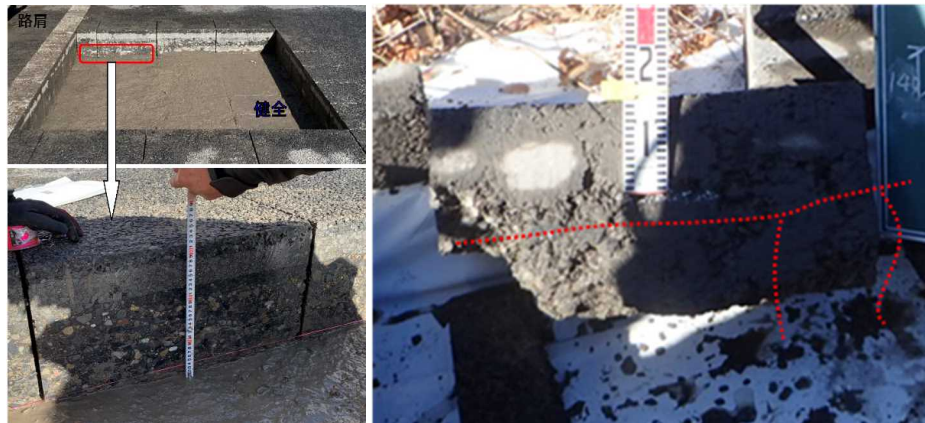
図5 下層路盤の永久変形
