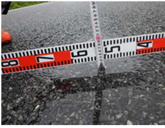
図-13 IWP位置の局部沈下 (KP 255.500~KP 255.510)
