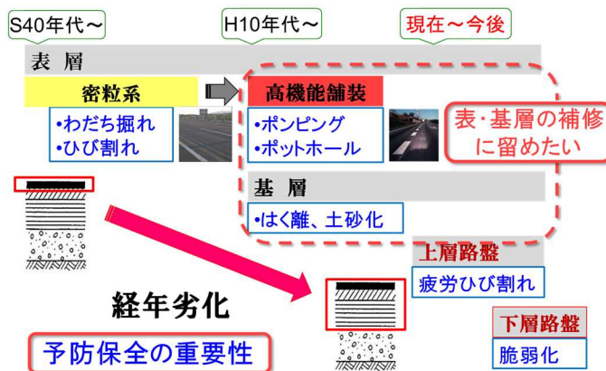
図-2 舗装損傷の深層化
